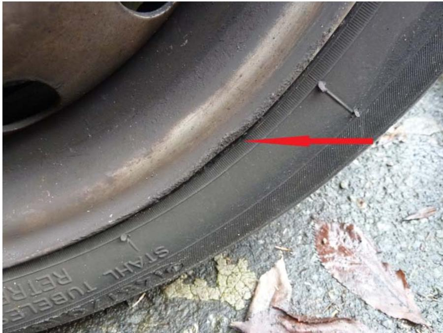
Leichte Verformung am Felgenhorn und leichter Abrieb
