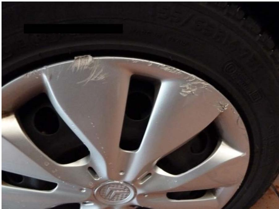
Starke Oberflächenschäden mit Materialverschiebung
