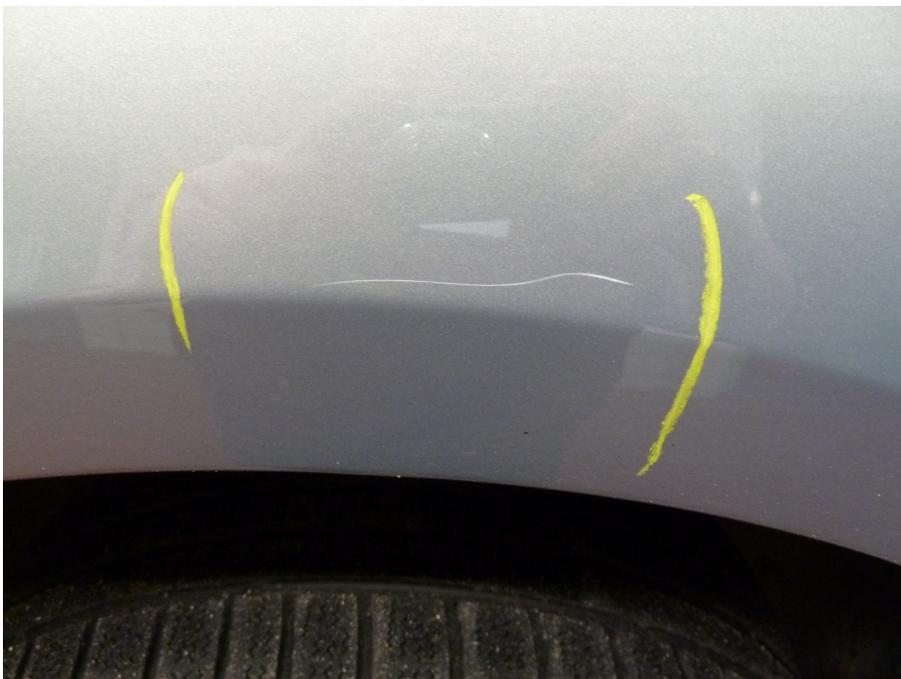
Kratzer länger als 1cm (nicht durch polieren zu entfernen)
