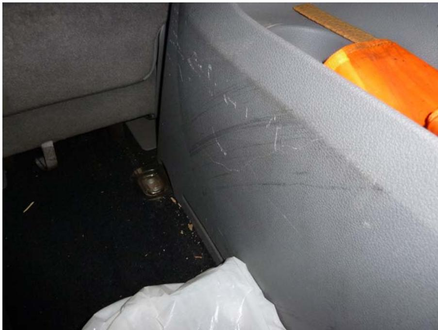
Leichter Oberflächenschaden an der Kofferraumverkleidung
