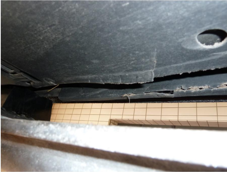
Verkleidung am Unterboden stark beschädigt
