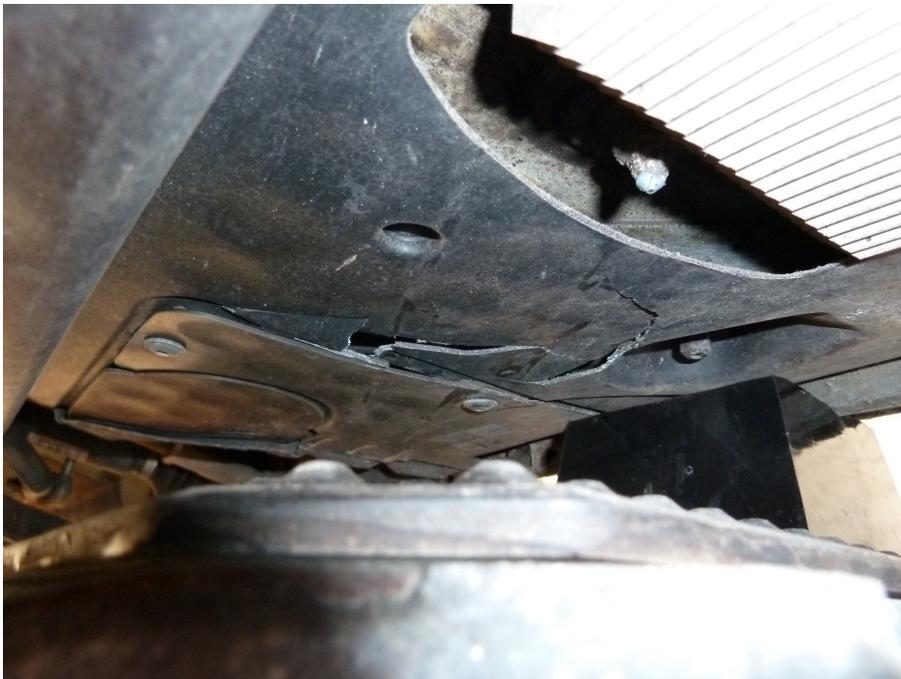
Verkleidung am Unterboden stark beschädigt
