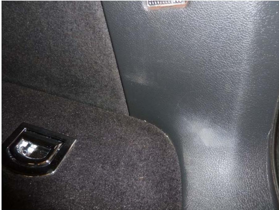
Leichter Oberflächenschaden an der Seitenwandverkleidung
