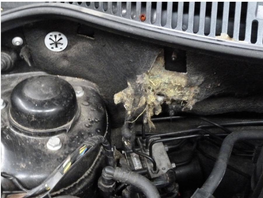
Motorraumisolierung beschädigt (Stirnwand)
