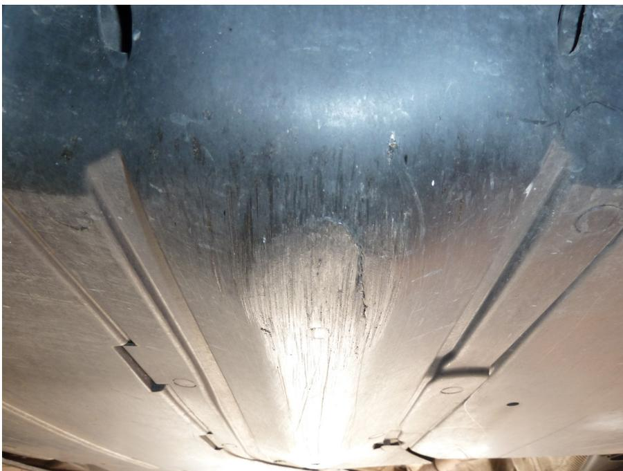
Verkleidung am Unterboden leicht beschädigt
