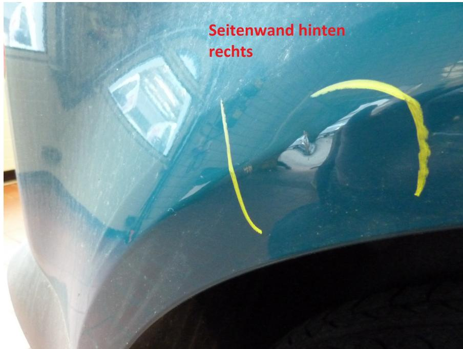
Kleine Delle im Radlauf (kein smart repair möglich)
