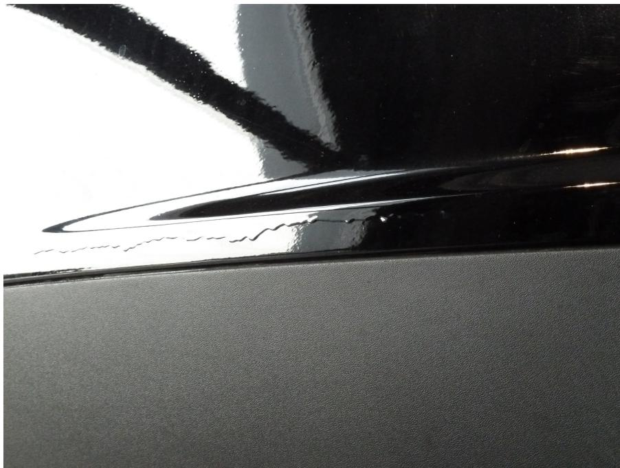
Lacknasen nach Instandsetzungslackierung
