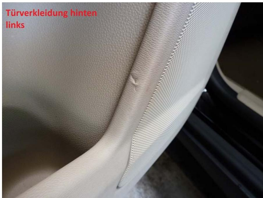
Oberflächliche Beschädigung an der Türverkleidung
