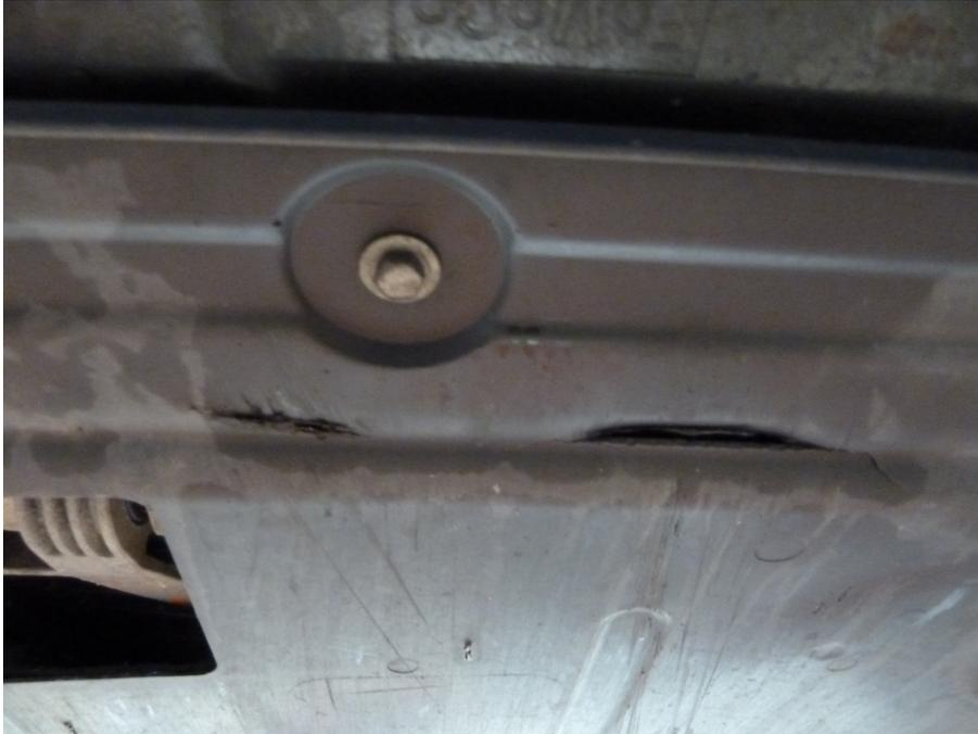
Verkleidung am Unterboden leicht beschädigt
