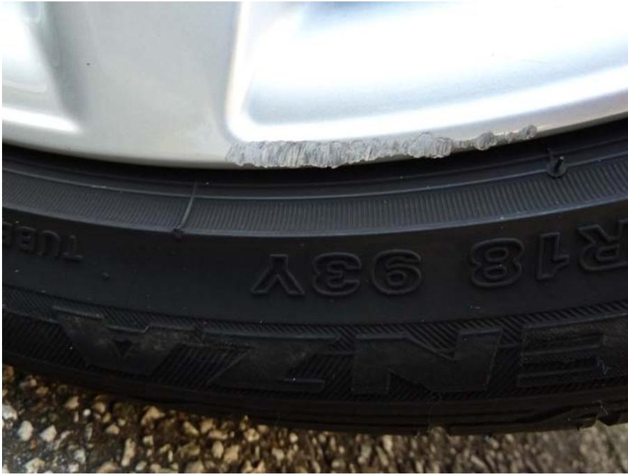
Starke Oberflächenschäden mit Materialverschiebung
