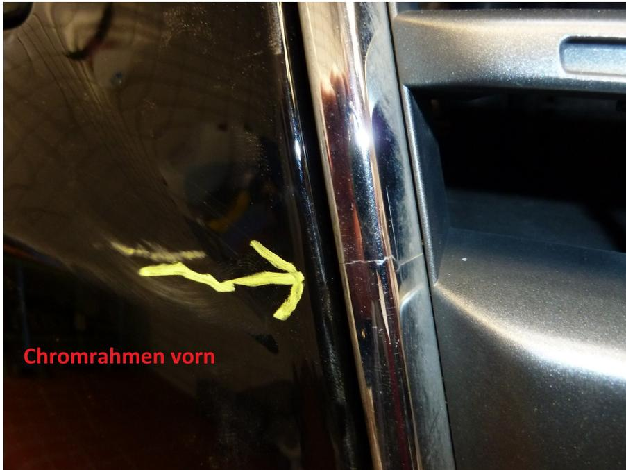
Beschädigte Zierteile / Chromteile außen
