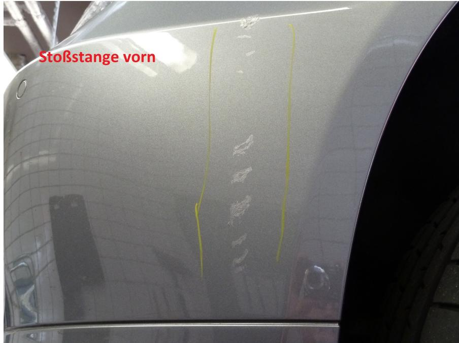
Mit Lackstift ausgebesserte Fahrzeugteile
