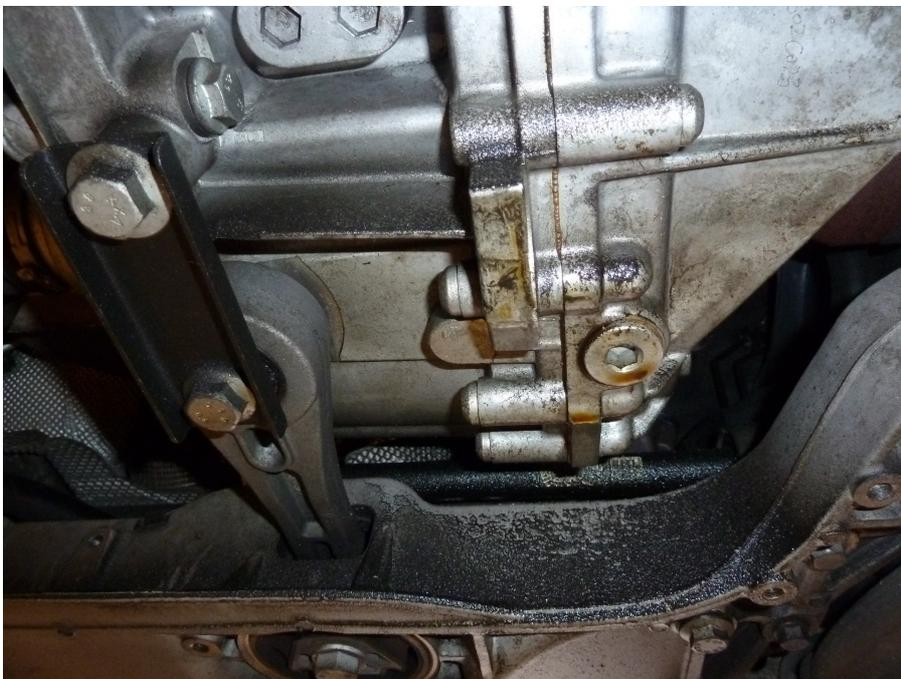
Getriebe Öl undicht
