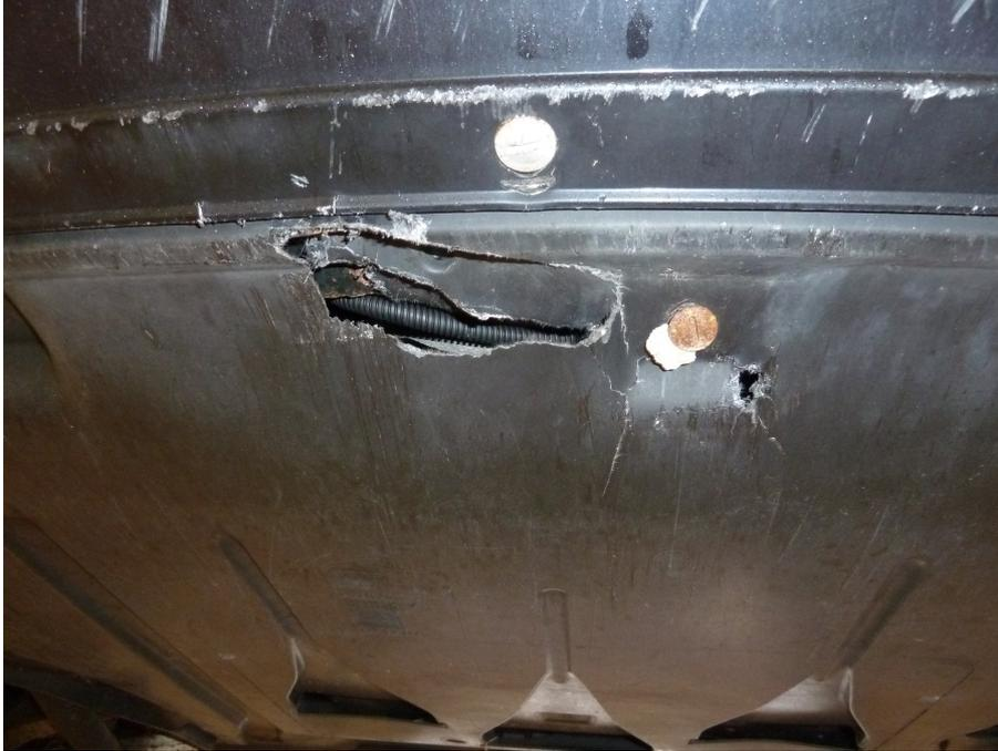
Verkleidung am Unterboden stark beschädigt
